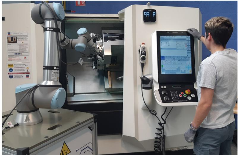
L'intérêt du robot collaboratif dans cette application : il peut être utilisé sur plusieurs machines en fonction des besoins.
