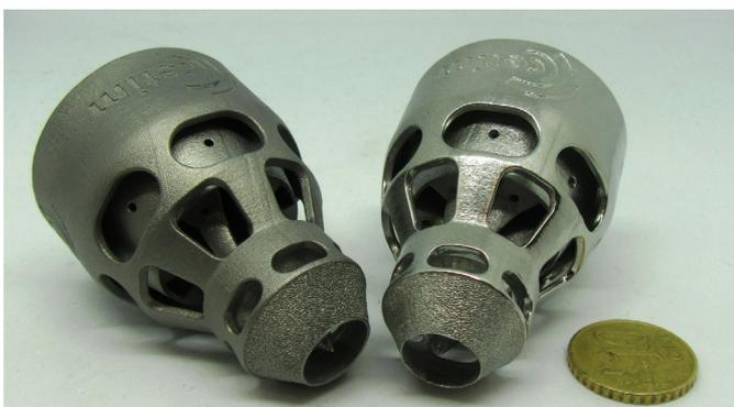
Avant de pouvoir être utilisées, les pièces produites avec le procédé Metal Binder Jetting (MBJ) nécessitent une dernière étape de frittage.
