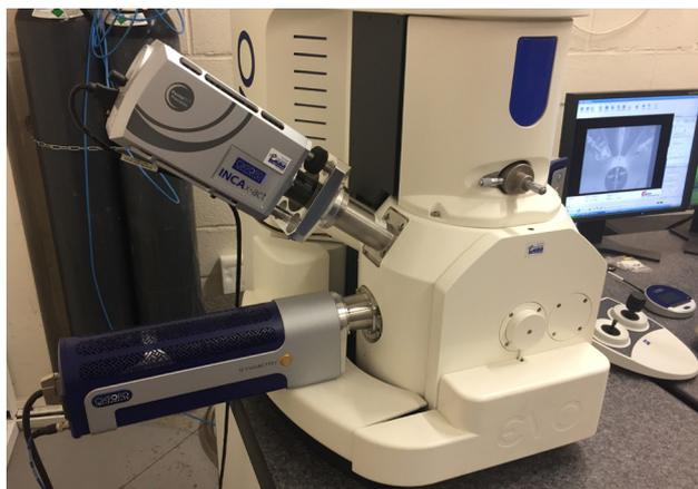
La technique Electron BackScattered Diffraction (EBS) permet de dresser la cartographie des orientations de cristaux ainsi que celles des phases.
