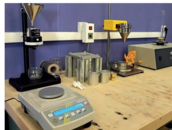
Appareils de mesure de la coulabilité des poudres
