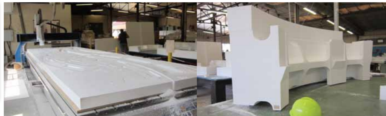
> Station de Stratoconception® installée par le CIRTES dans l'entreprise Ferry Capitain (capacité de 6 m x 2 m) : exemple de modèle réalisé (1/8 de couronne de 8 m de diamètre)
